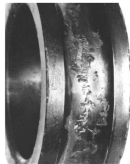
Figura 13. Rodamiento de bolas con la pista desgastada por fatiga [38].
