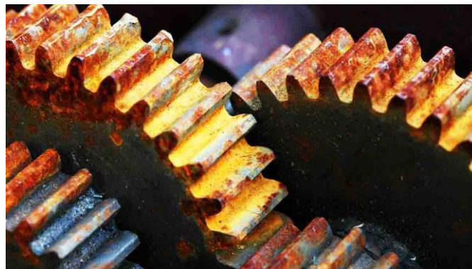
Figura 15. Desgaste químico de piezas en deslizamiento.
