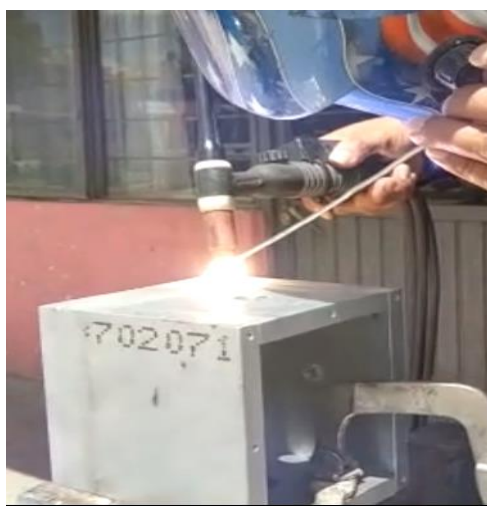
Figura 70. Proceso GTAW para soldadura de la caja de lubricación.
