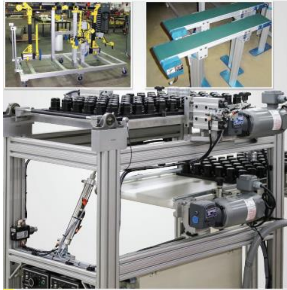
Figura 6. Ejemplo de aplicaciones de los perfiles extruidos de aluminio marca 80/20.
