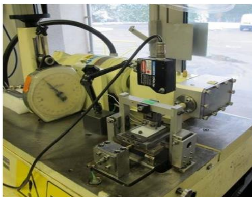
Figura 26. Tribómetro lineal recíprocante modelo Plint 77 [42].
