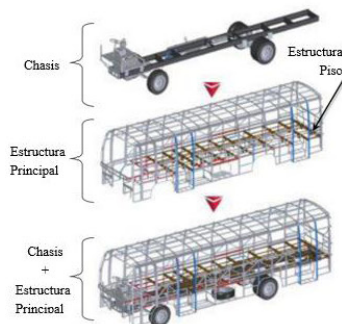
Figura 1-Estructura de autobús urbano del tipo: Estructura sobre chasis.
