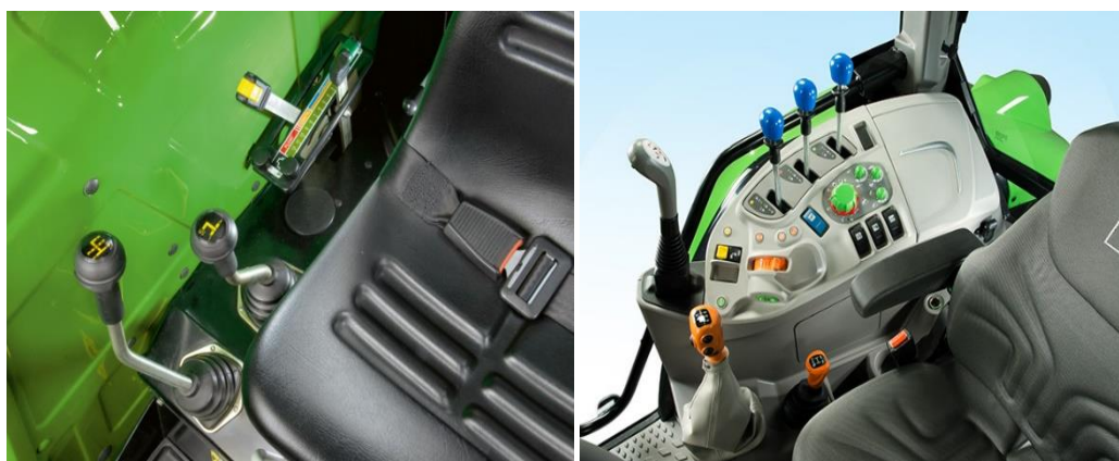
Figura 4. Mandos de cabina de la toma de fuerza de los tractores de la marca Deutz Fahr.
