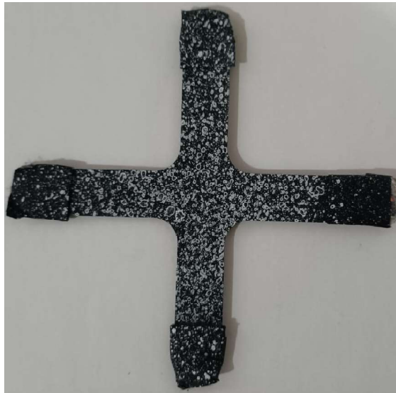
Figura 76. Probeta con fisura a 20° con moteado en color blanco mate
