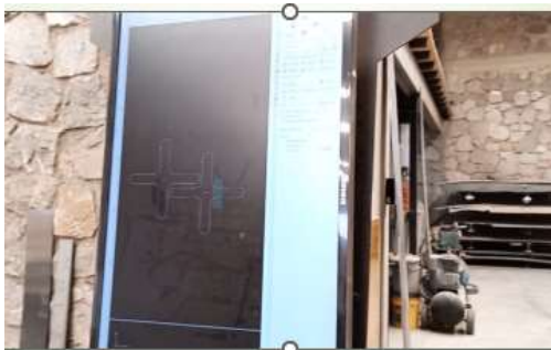
Figura 71. Importación del CAD a máquina CNC
