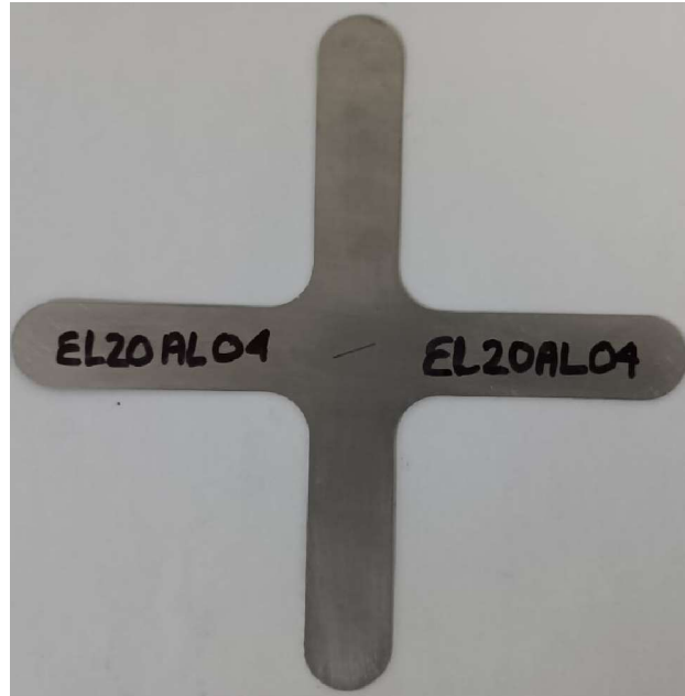
Figura 77. Probeta con fisura a 20° marcada con nomenclatura correspondiente
