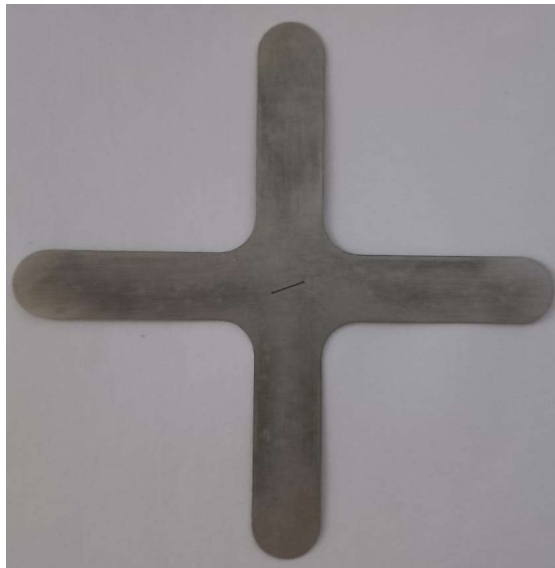
Figura 73. Probeta con fisura a 20° limada y lijada
