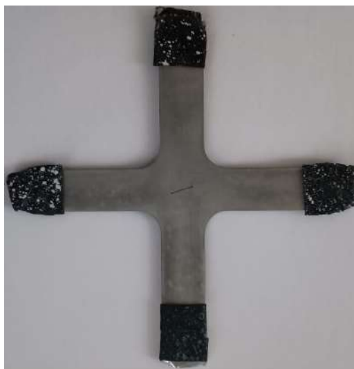
Figura 74. Probeta con fisura a 20° con extremos protegidos
