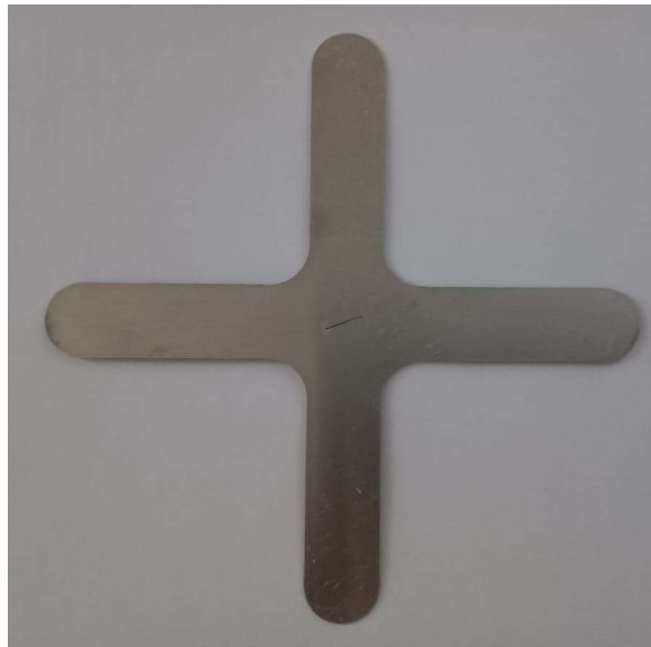
Figura 72. Probeta con fisura a 20°
