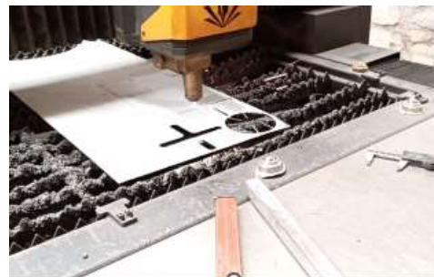
Figura 70 Ensayo de corte para evaluar la muesca (fisura)
