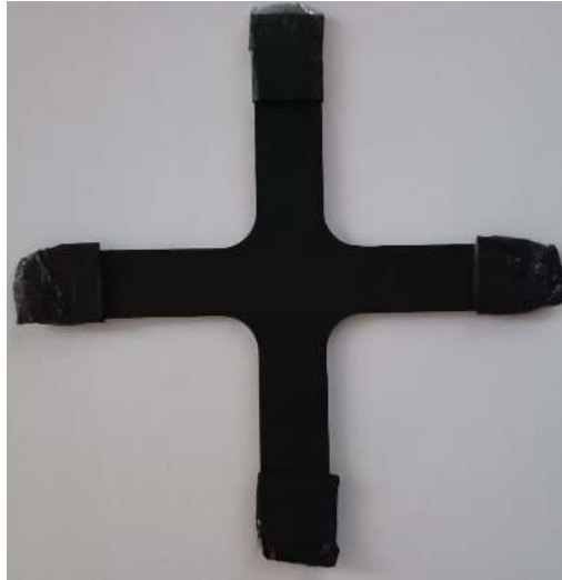
Figura 75. Probeta con fisura a 20° con base de esmalte negro mate
