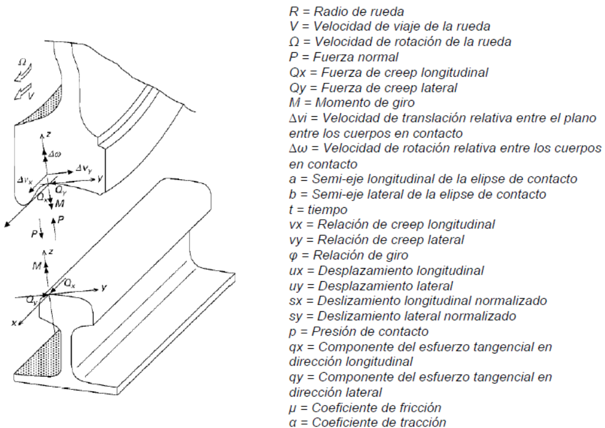
Figura 20. Representación esquemática de las variables presentes en un contacto rueda-riel [28].
