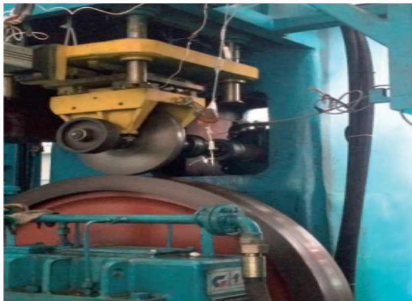
Figura 15. Tribómetro estático de simulación de ruedas y rieles féreos [22].
