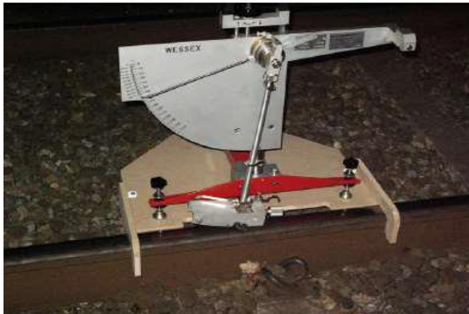
Figura 6. Equipo de péndulo portátil [6].
