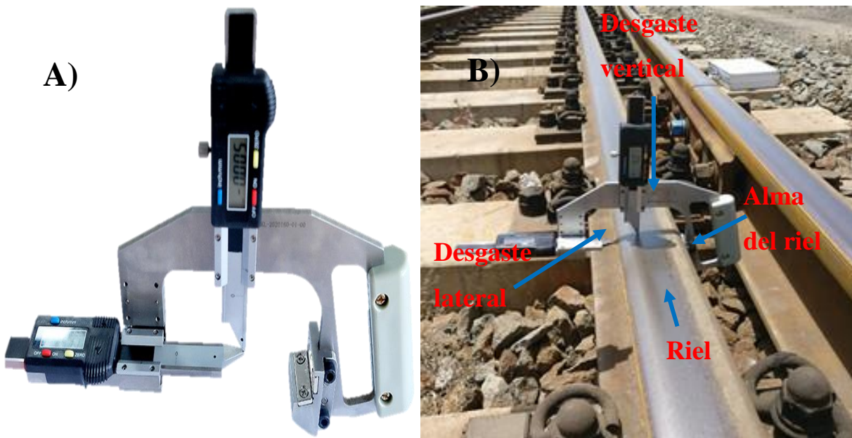
Figura 9. A) Medidor digital, B) Aplicación de un medidor digital en un riel férreo [12].
