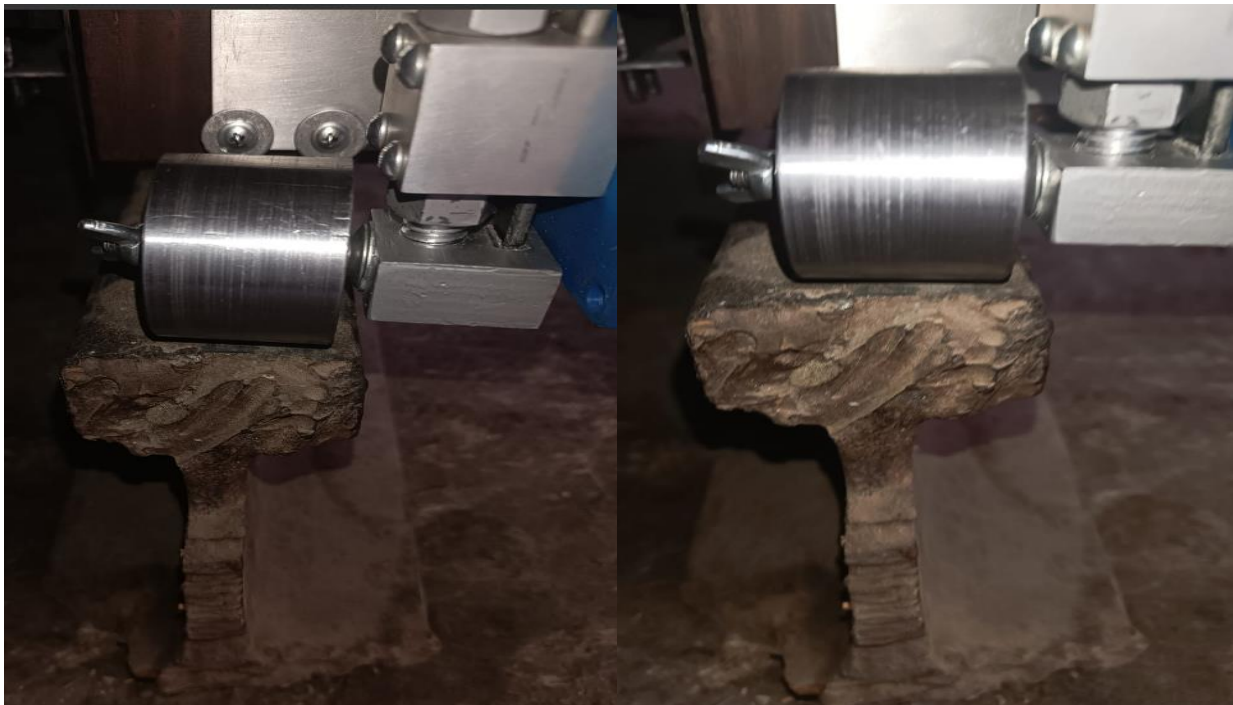
Figura 98. Contacto rueda-riel para la obtención de resultados en la banda de rodadura.
