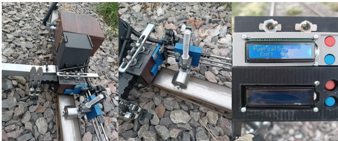
Figura 89. Pruebas en banda de rodadura de la vía y muestra de resultados.
