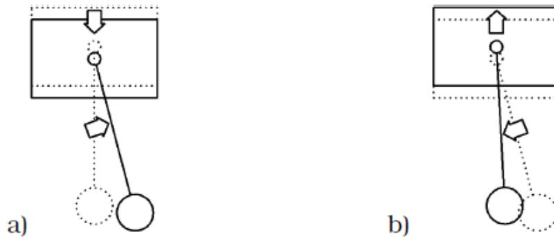
Figura 10 Funcionamiento del absorbedor de vibraciones autoparamétrico [18].
