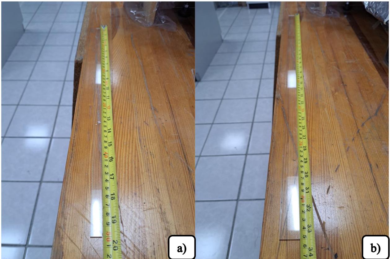
Figura 84. Probetas de acrílico a) Longitud de 0.5 m, b) Longitud de 0.85 m.
