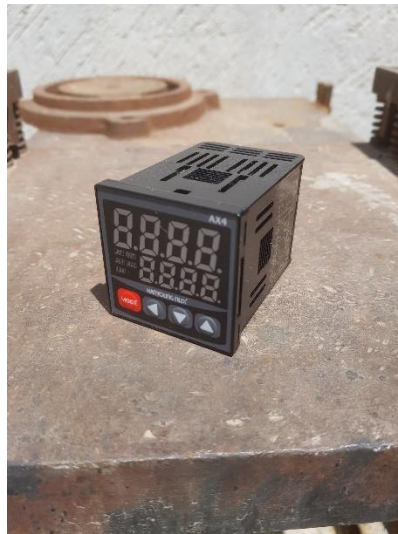
Figura 37. Controlador de temperatura.
