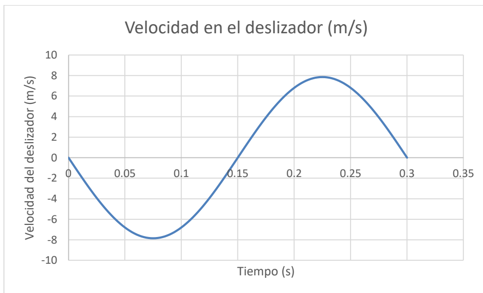
Figura 60. Velocidad en el deslizador contra tiempo a 3000 rpm.
