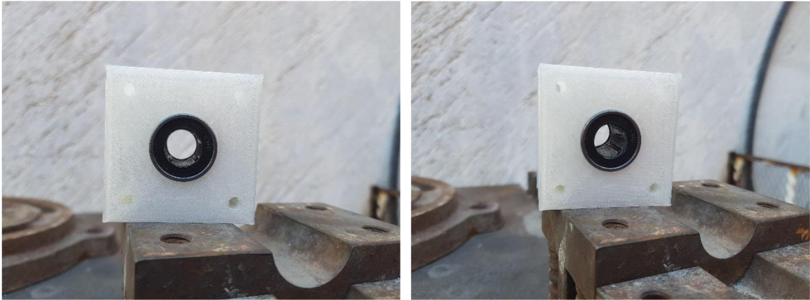
Figura 15. Balero de guías lineales con marco impresión 3D.
