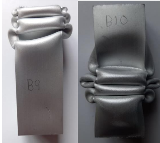
Figura 103. Deformación de las probetas con la muesca a 50% de la longitud total.
