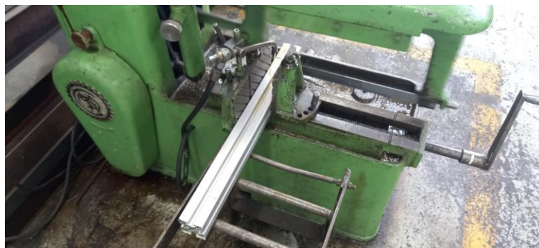
Figura 46. Corte de perfil de aluminio.
