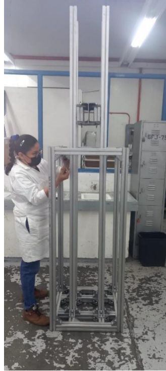
Figura 51. Estructura con el percutor montado.
