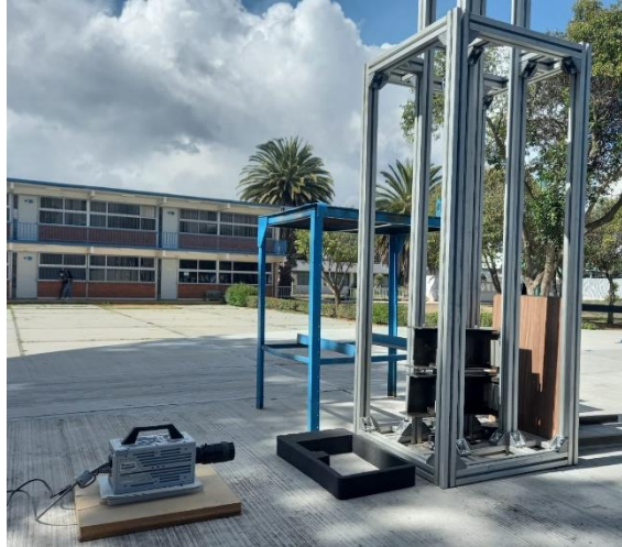
Figura 78. Montaje de la cámara de alta velocidad.
