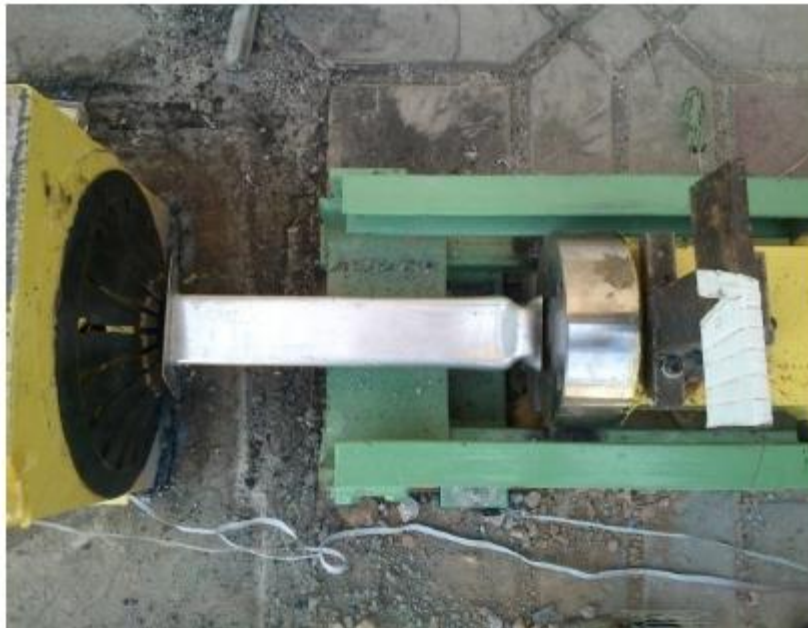
Figura 2. Sistema de impacto con soporte elástico. [3]
