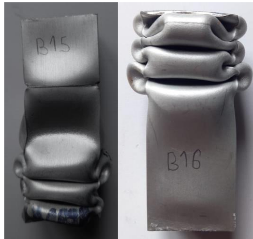
Figura 115. Deformación de las probetas con la muesca a 80% de la longitud total.
