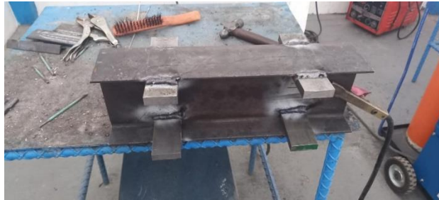
Figura 49. Perfil con soleras soldadas.
