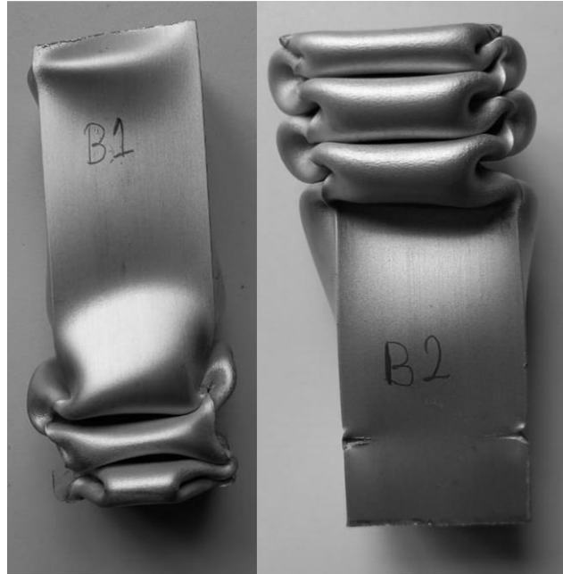
Figura 87. Deformación de las probetas con la muesca a 10% de la longitud total.
