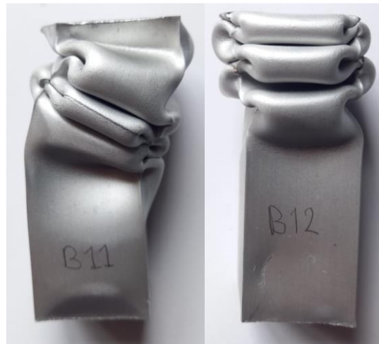
Figura 107. Deformación de las probetas con la muesca a 60% de la longitud total.
