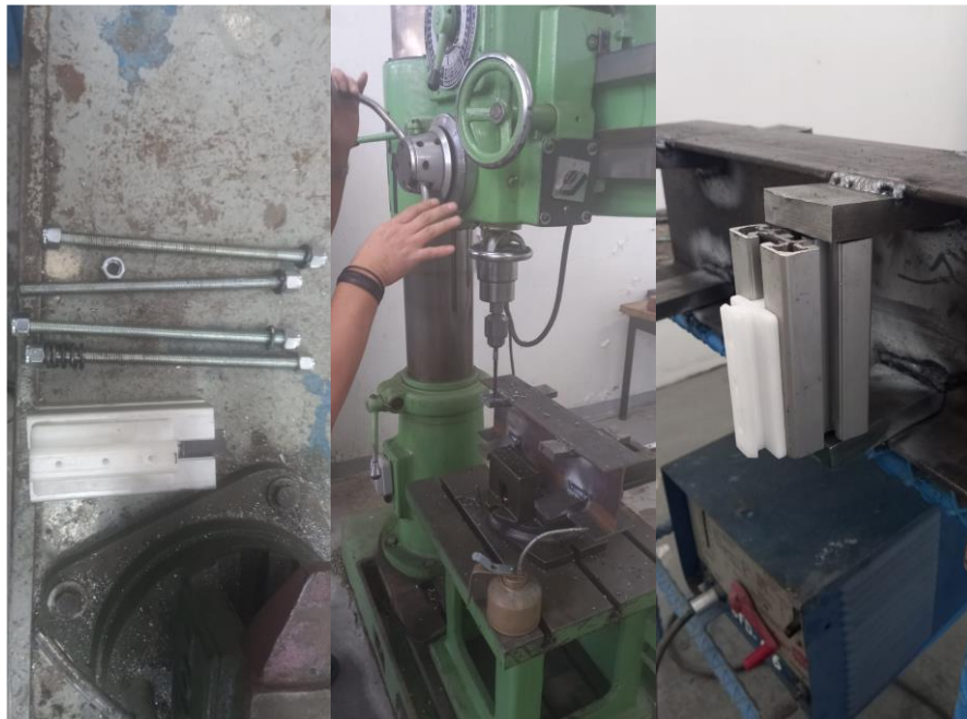
Figura 50. Colocación de las guías en el percutor.
