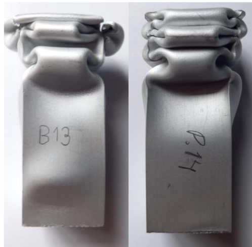
Figura 111. Deformación de las probetas con la muesca a 70% de la longitud total.
