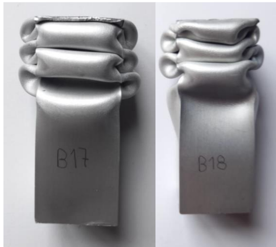
Figura 119. Deformación de las probetas con la muesca a 90% de la longitud total.
