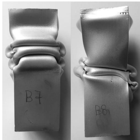
Figura 99. Deformación de las probetas con la muesca a 40% de la longitud total.
