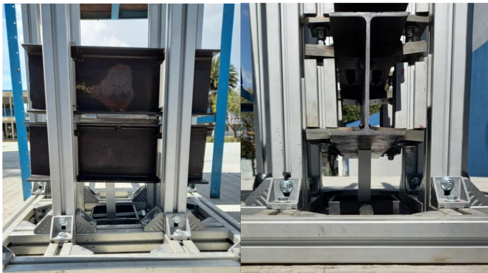
Figura 77. Montaje de la probeta en la máquina de pruebas de impacto.
