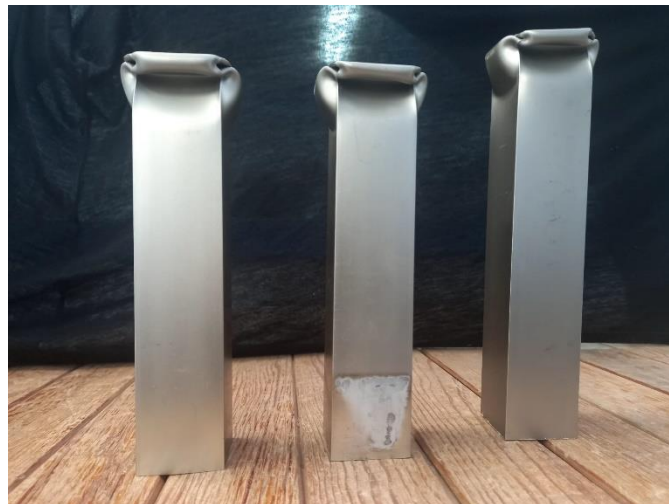
Figura 73. Probeta de 0.0381m (1.5 pulgadas) deformada.
