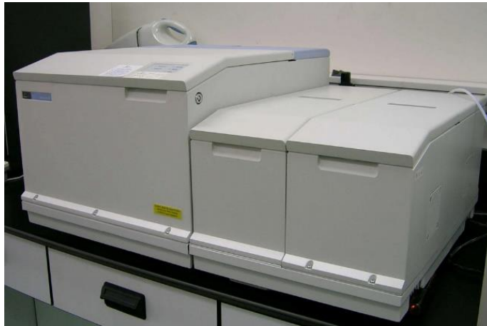
Figura 15. Espectrofotómetro de Infrarrojo con Transformada de Fourier (FTIR) modelo Spectrum GX, Perkin Elmer.
