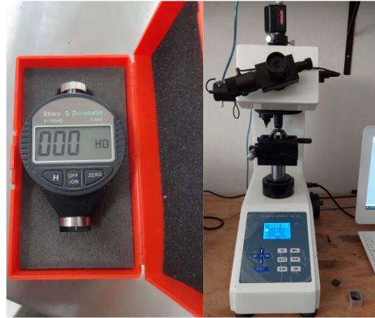
Figura 13. Durómetro Shore D y Micro-Vickers Hardness 412 DAT, Bowers.
