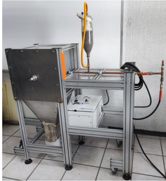
Figura 17. Máquina de erosión horizontal.
