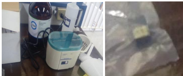
Figura 17. Baño ultrasónico y agua destilada para la limpieza de muestras en el Laboratorio de Metalografía del I.T. Pachuca
