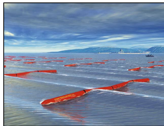
Fig. 5 Representación gráfica de una granja undimotriz con dispositivos Pelamis [9].
