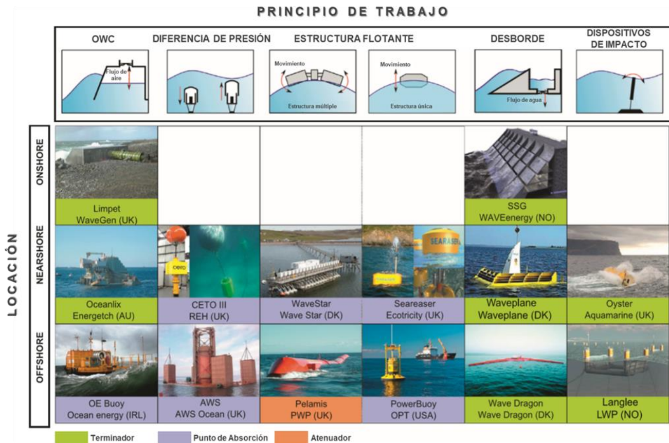
Fig. 15 Representación gráfica de la clasificación de dispositivos undimotrices por su principio de funcionamiento y localización (términos generales).
