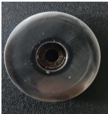
*Figura 57. Desgaste del disco lubricación con agua.*
