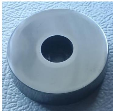
*Figura 56. Desgaste del disco lubricación con aceite.*
