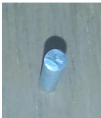
*Figura 58. Desgaste del perno lubricación con aceite.*
