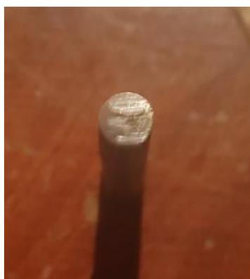
*Figura 59. Desgaste del perno lubricación con agua.*
