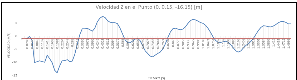
Figura 105: Gráfica de velocidad en Z contra el tiempo en el punto (0, 0.15, -16.15); para simulación sin rejilla con rotación malla deslizante t=1.5s .
