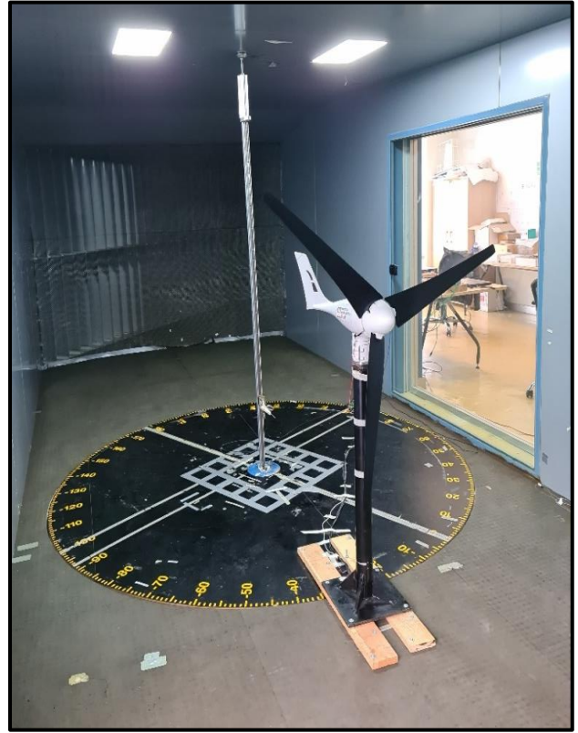
Figura 17: Aerogenerador comercial utilizado, montado sobre la torre a 1D del anemómetro de hilo caliente ambos sobre la mesa N°2.
