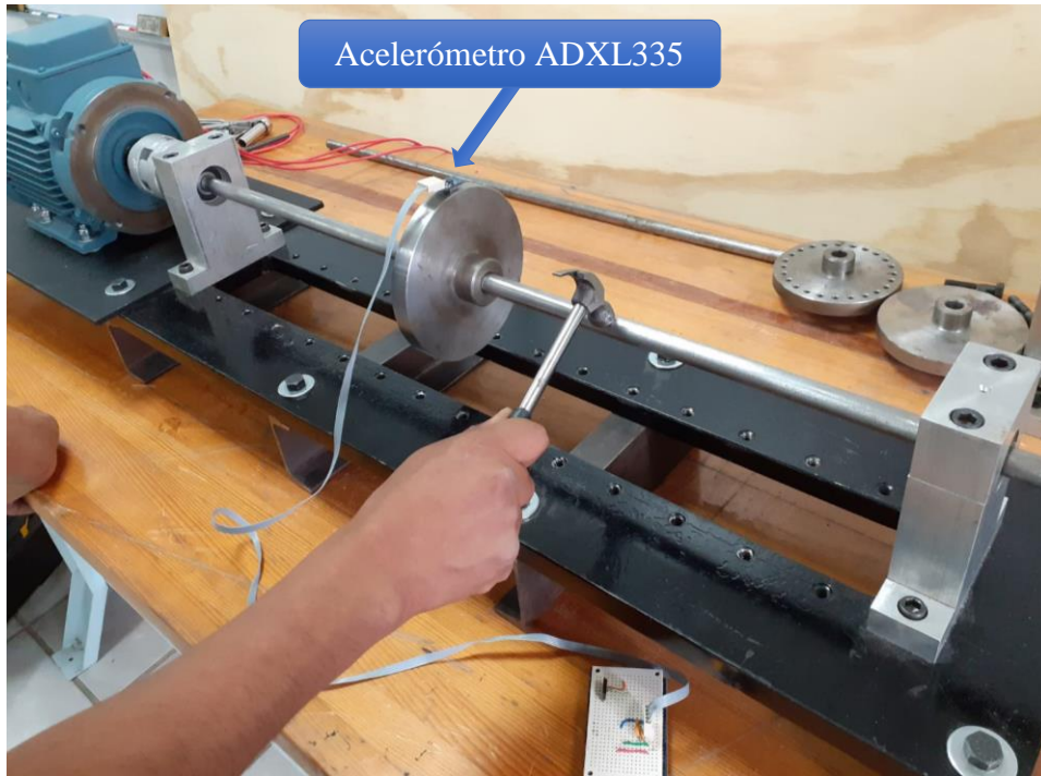
Figura 5.26 Prueba con excitación tipo impacto.
