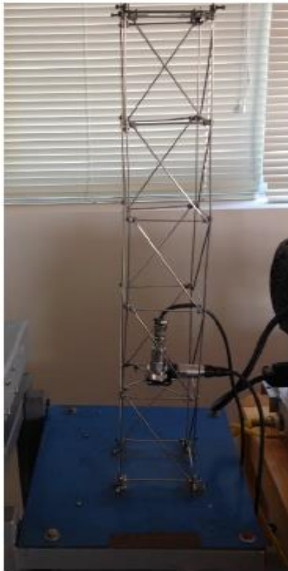
Figura 2.2 Banco de ensayos modales perteneciente al laboratorio del departamento de Ingeniería Mecánica de la universidad del BÍO-BÍO [27].
