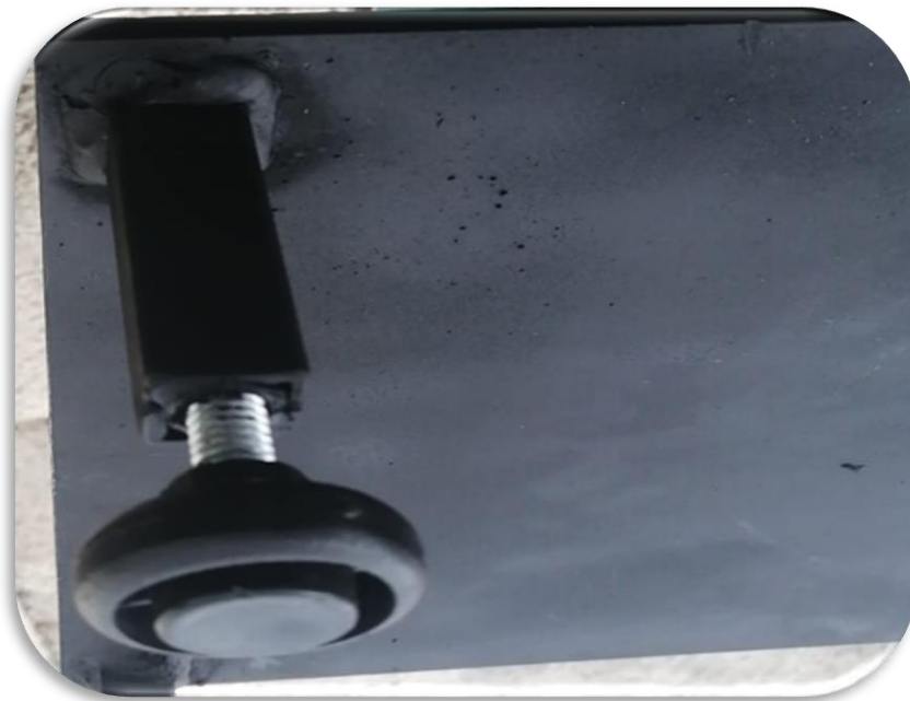
Figura 5.19 Niveladores soporte de motor.
