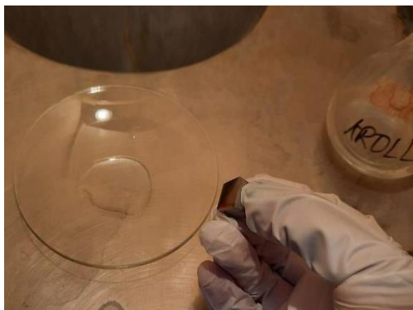
Figura 28. Proceso de ataque químico.
