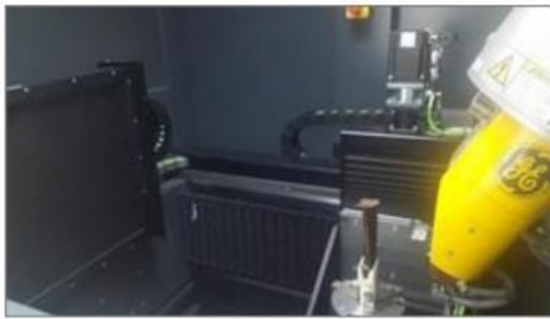
Figura 4 - Arreglo experimental del álabe para el análisis por Tomografía Computarizada de rayos-X.
