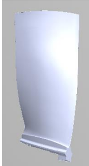
Figura 29. Modelo en CAD obtenido del álabe.
