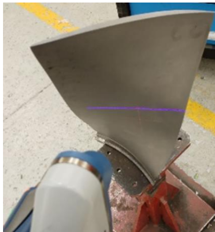
Figura 11. Proceso de medición transversal del álabe.
