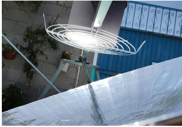
Figura 54- Punto focal de la estufa solar debajo de la olla de cocción.
