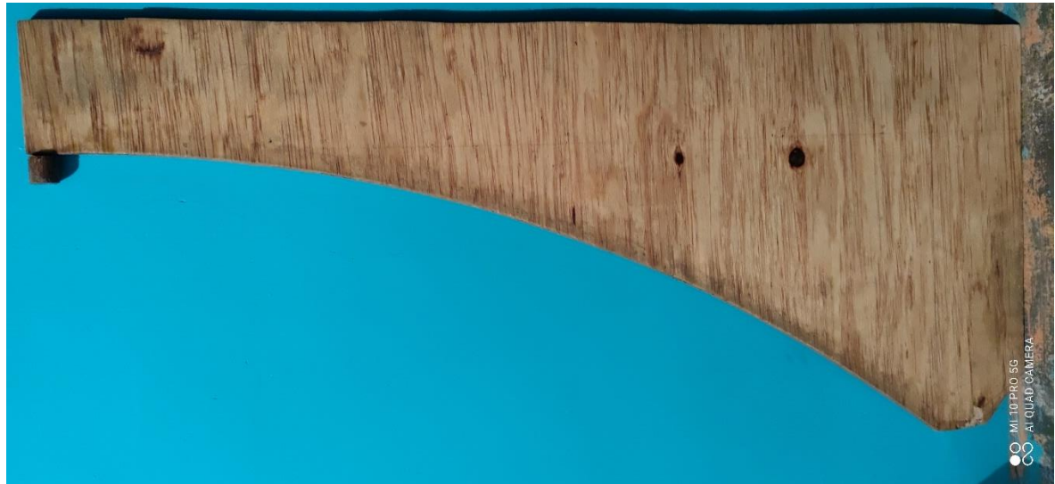
Figura 23- Corte de la pieza de triplay para realizar el molde.
