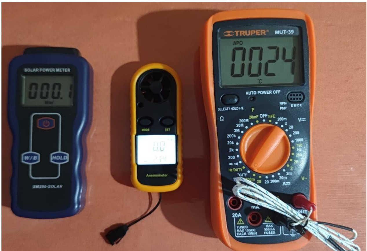
Figura 51- Instrumentos de medición, medidor de radiación solar directa SM206-solar, anemómetro y multímetro Truper MUT-39.
