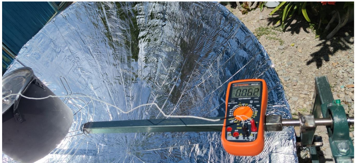
Figura 56- Comienzo de las pruebas con el papel Mylar como material reflejante.
