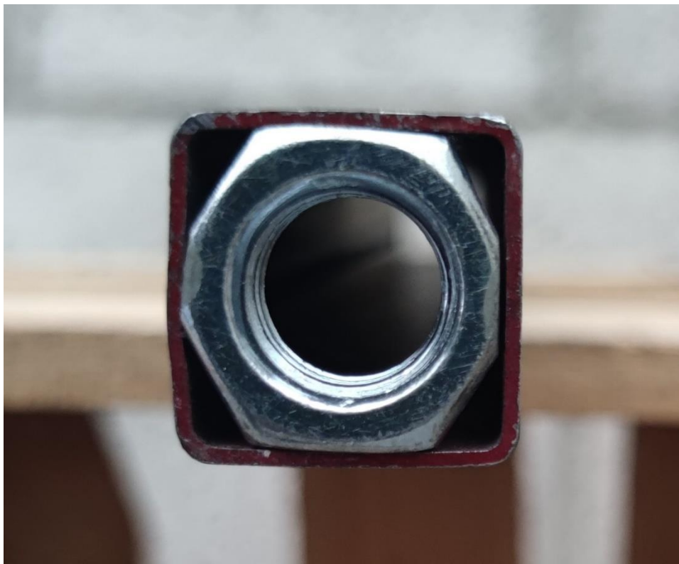
Figura 40- Tuerca de 5/8 de pulgada dentro del perfil tubular.
