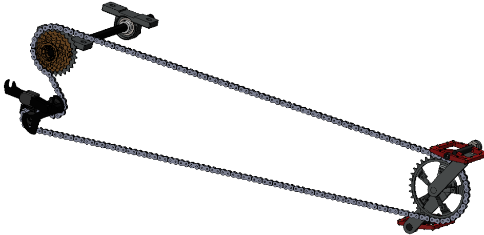
Figura 47. Sistema de transmisión de 0.9 m de separación entre piñones
