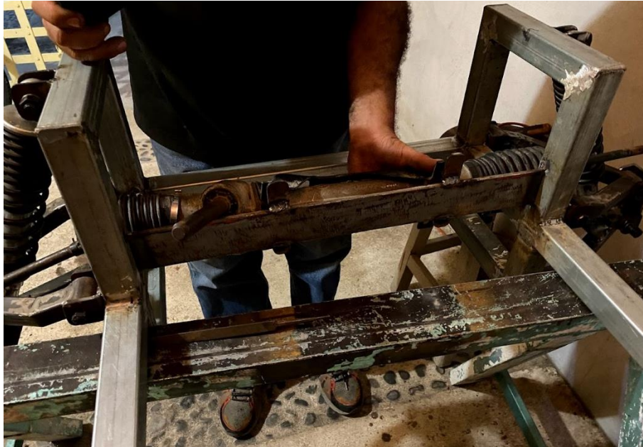
Figura 63 Sistema de dirección ensamblado en el bastidor
