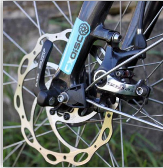
Figura 24. Sistema de frenos mecánicos de disco para bicicleta
