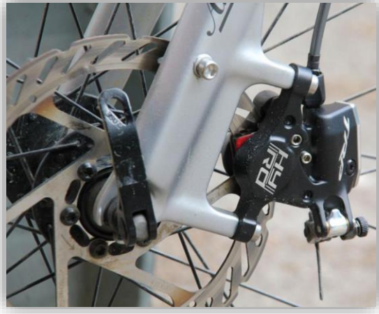
Figura 25. Sistema de frenos mecánicos de disco para bicicleta
