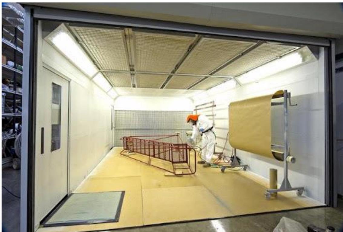
*Figura 19. Cabina para recubrimiento de flujo (Ferreiro, 2018)*
