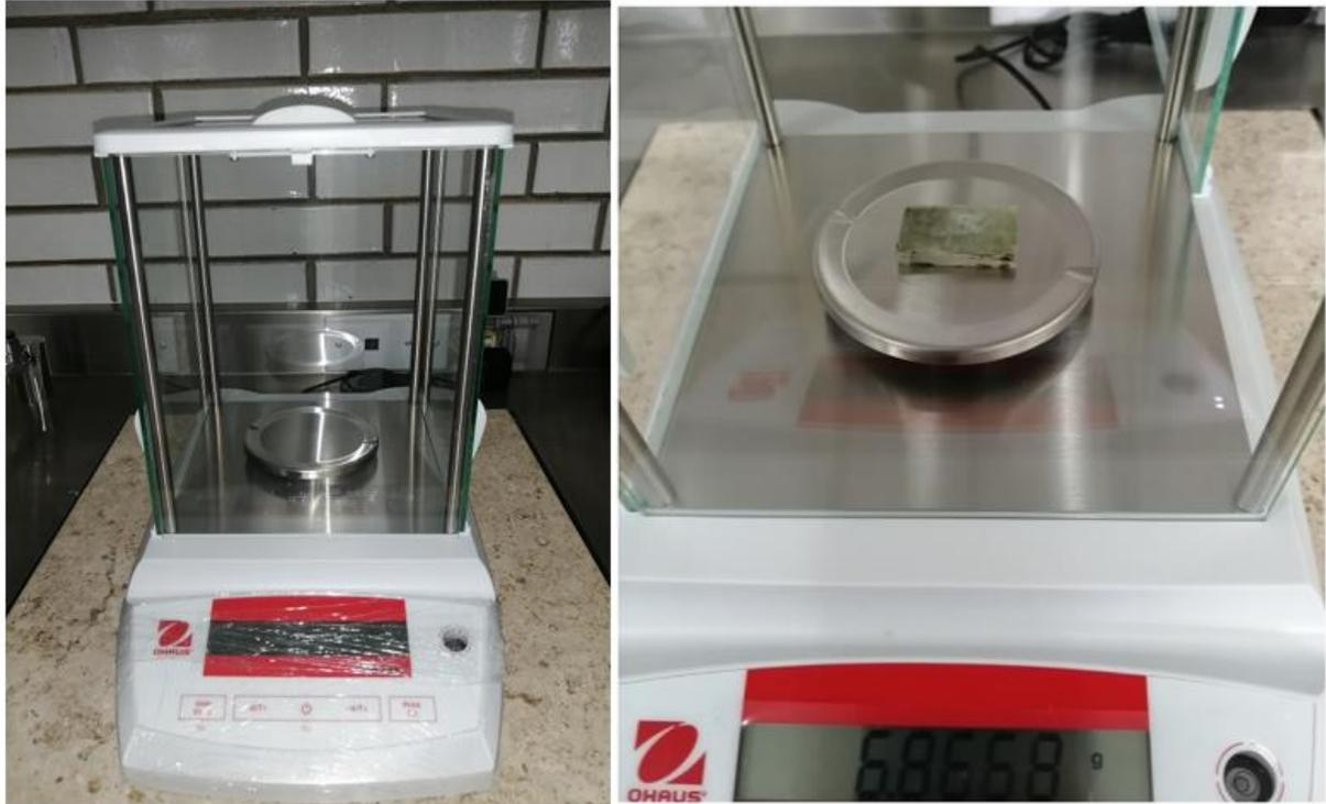
*Figura 53. Balanza analítica Ohaus PX124/E Pioneer*
