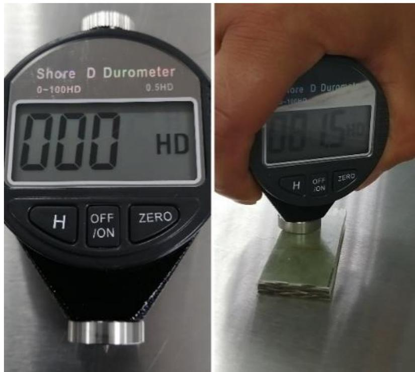
*Figura 50. Durómetro Shord-D*
