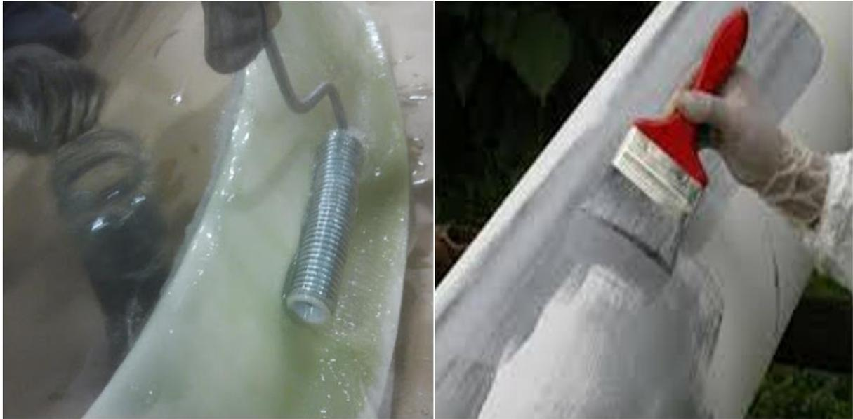
*Figura 16. Recubrimiento por método de rodillo y brocha (Fibraplus, 2015)*
