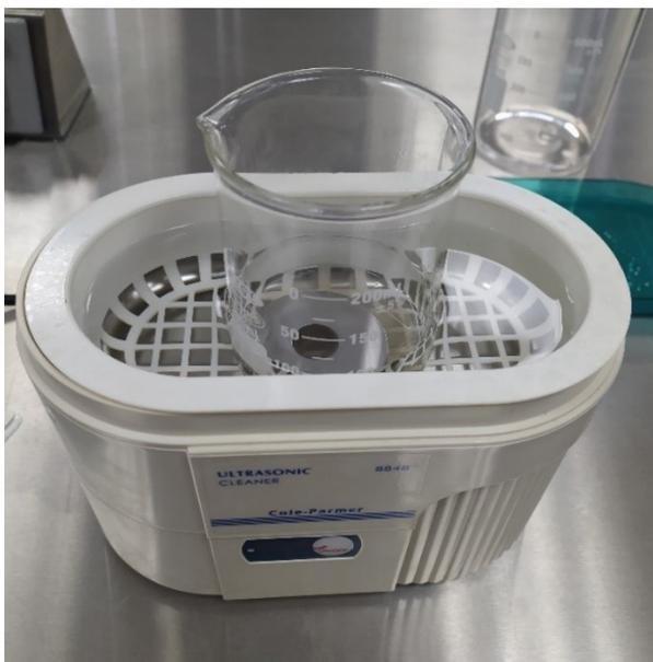
*Fig. 25 Procedimiento- Limpieza de probetas antes de las pruebas tribológicas*
