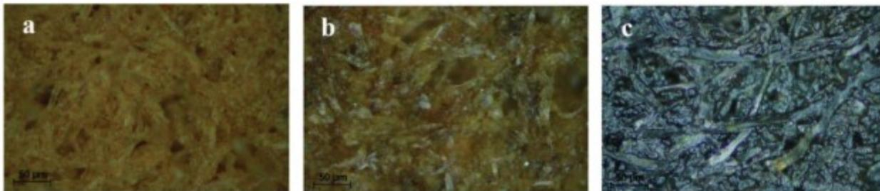
Fig. 4 Imágenes de las superficies de muestra del material tomadas con un microscopio óptico: (a) muestra nueva; (b) muestra después de la prueba de ATF-DEX RON III puro; y (c) muestra después de la prueba de aceite puro de *Jatropha*
