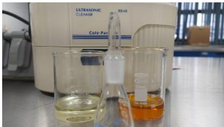
Fig. 16 Picnómetro. Cálculo de la densidad de los aceites
