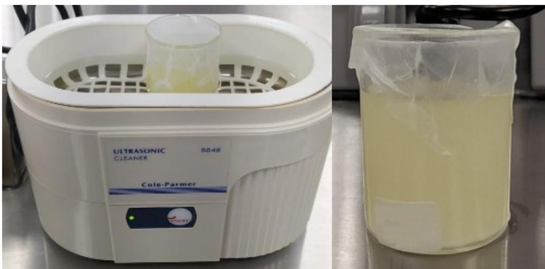
Fig. 18 Dispersión de nanopartículas en tina ultrasónica del aceite de sésamo con una concentración de 0.25%
