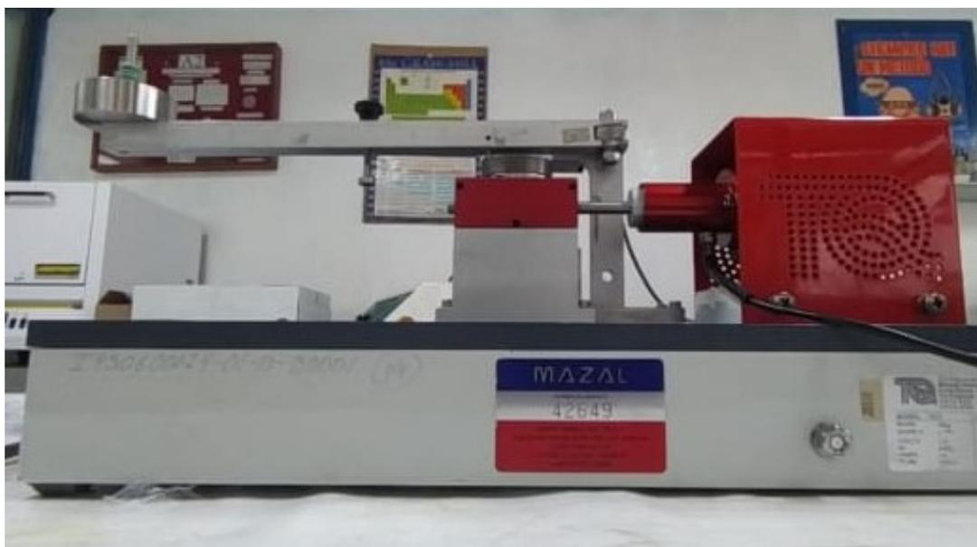
Fig. 21 Máquina perno sobre disco, utilizada para pruebas de desgaste y fricción.
