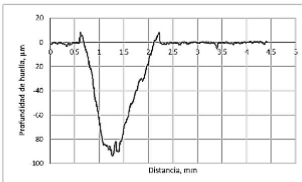
Figura 11 - Perfilometría de la huella de desgaste del disco evaluado con JC + 0.25% Al<sub>2</sub>O<sub>3</sub>
