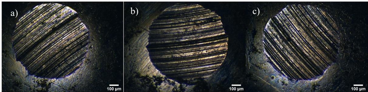
Fig. 113 Huellas de desgaste de la prueba de sésamo+ 0.25% de nanopartículas de  $Al_2O_3$  bajo la norma ASTM D-4172 a) Bola 1 b) Bola 2 c) Bola 3
