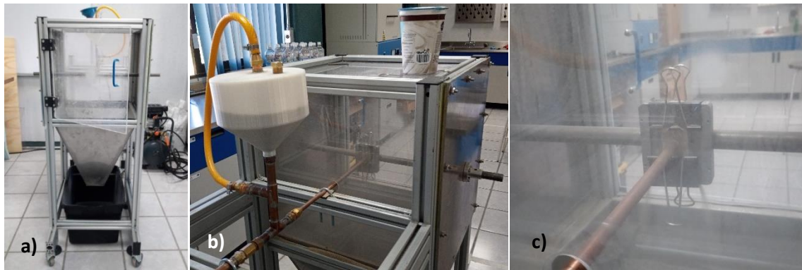
Figura 26. a) Vista general, b) Contenedor de arena y c) espécimen en el portamuestras.
