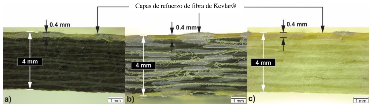
Figura 19. Espesor de materiales compuestos: a) PRFC-K, b) PRFH-K y c) PRFV-K.
