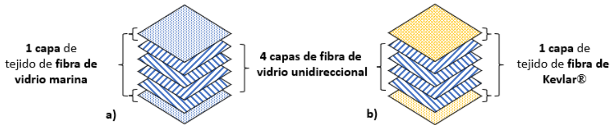
Figura 11. Compuestos laminados reforzados en su superficie. a) Con fibra de vidrio marina, b) Con fibra de Kevlar®.
