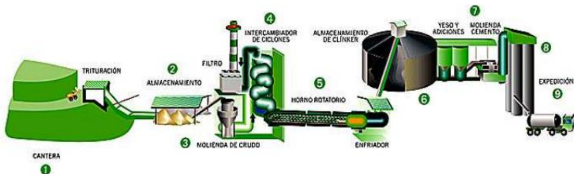
Fig. 12 Proceso general de la producción del cemento [50].
