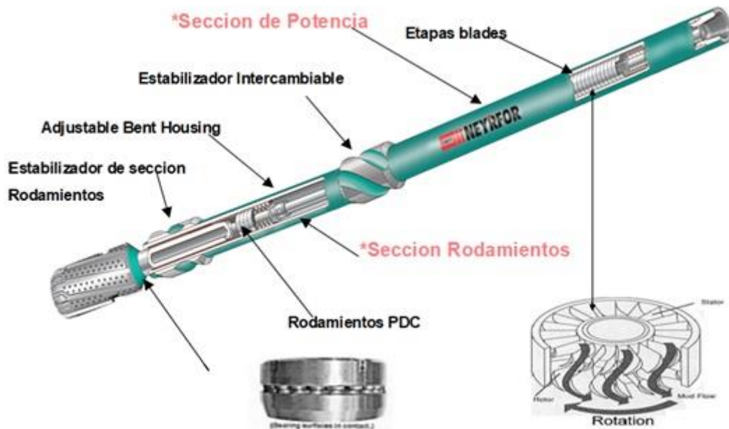
Figura 14. Motor hidráulico de turbinas para servicios de Tubería Flexible
