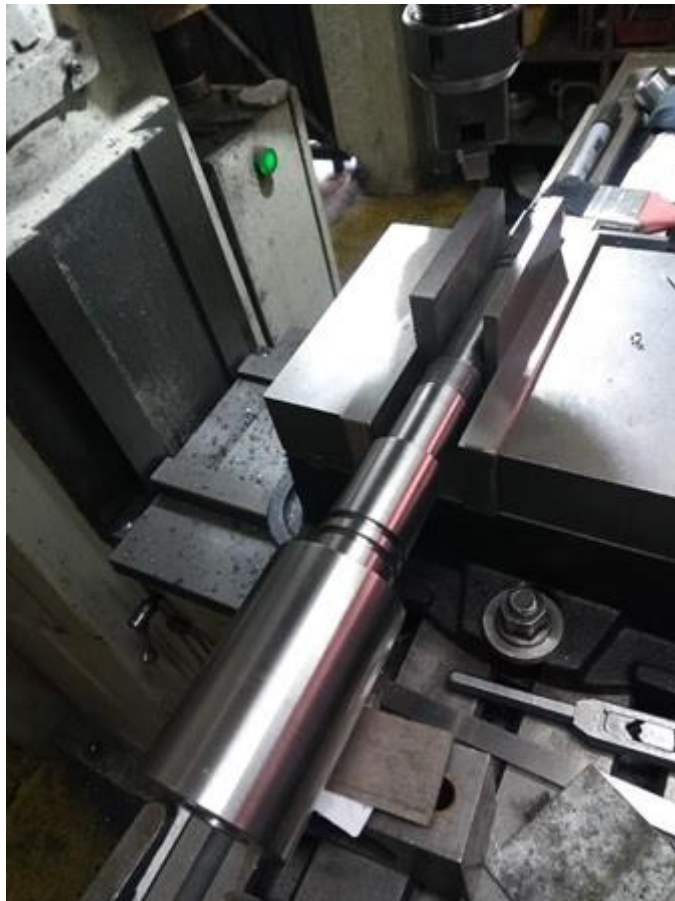
Figura 68. Maquinado de la flecha de la sección de carga
