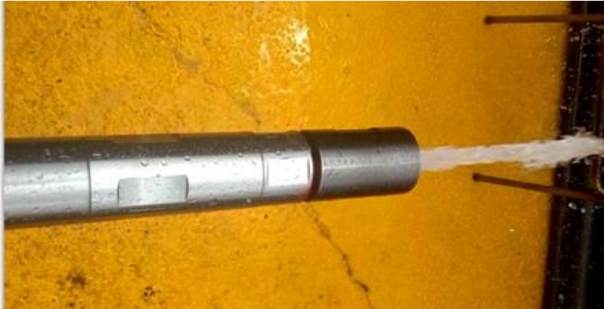
Figura 79. Prueba rotacional de la sección de carga
