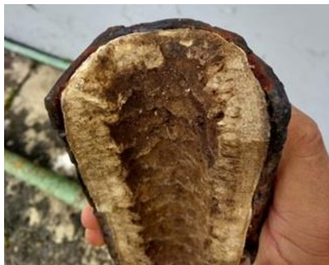
Figura 5. Problema típico de incrustaciones en una tubería de producción de hidrocarburos.
