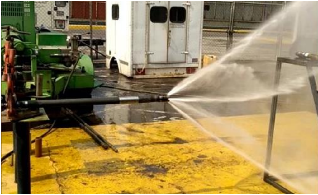
Figura 81. Prueba del funcionamiento del sistema hidromecánico con molino plano
