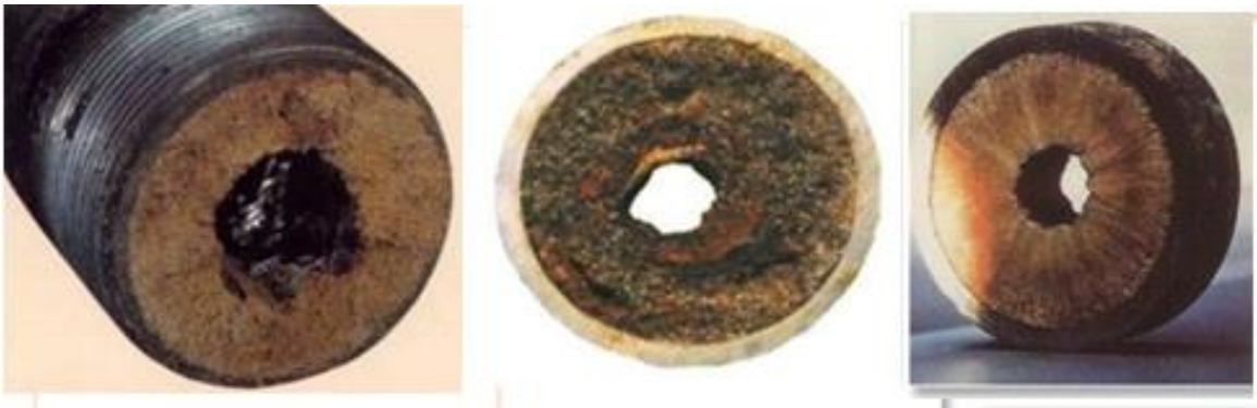
Figura 7. Problemática de depositaciones e incrustaciones en tuberías de producción
