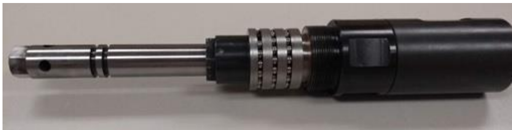
Figura 73. Ensamble de rodamientos de la sección de carga
