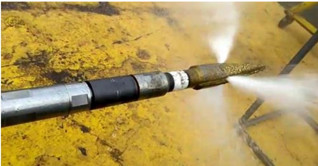
Figura 80. Prueba del funcionamiento del sistema hidromecánico con molino cónico
